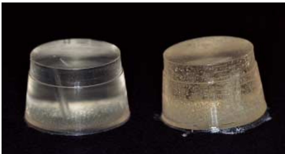
Fig. 12: Campioni in miscela di MMA/PMMA non colorato. Sinistra: con sistema di catalizzazione stabile a decolorazioni (a base di perossido/acido barbiturico). Destra: con un sistema di catalizzazione convenzionale (a base di ammina/perossido). Ripresa direttamente dopo la polimerizzazione
