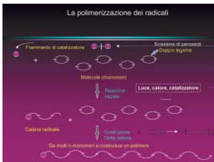
Fig. 3: raffigurazione schematica e semplificata della polimerizzazione dei radicali
