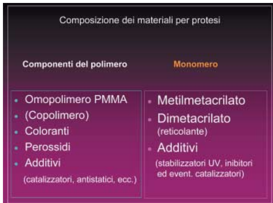
Fig 2: La composizione dei sistemi bicomponenti oggi-giorno maggiormente utilizzati su base MMA / PMMA .
