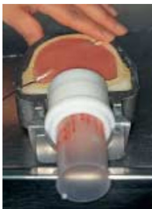
Fig. 7: Metodica dello studio: una sonda inserita sul lato anteriore e nelle vicinanze della diga termica misura il decorso di temperatura all'interno della muffola, durante la polimerizzazione di un campione in SR Ivocap Plus. Questo campione simula le condizioni in una protesi superiore piatta.
